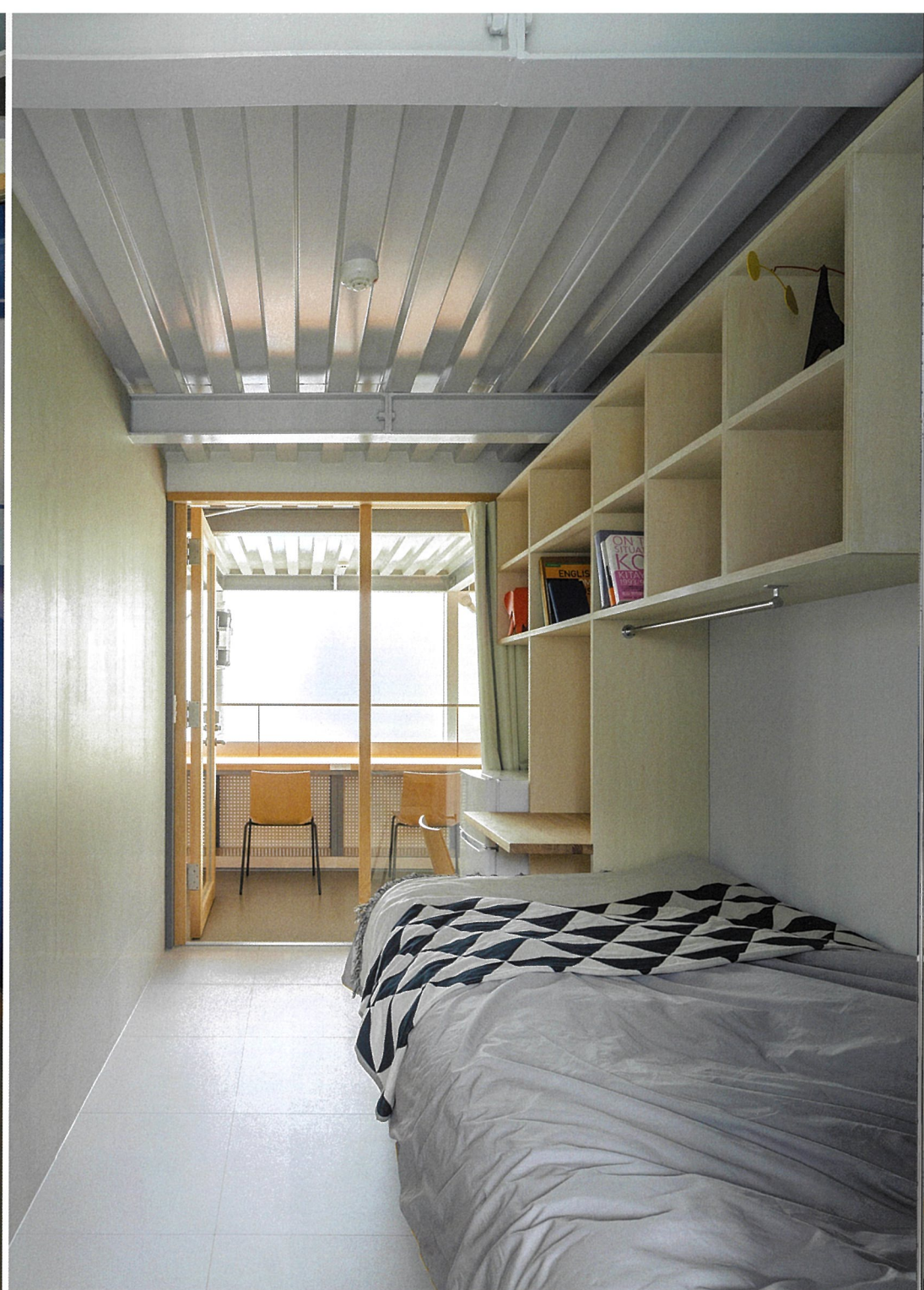
1住戸は間口2,100mm、奥行5,140mm、天井高2,250mmで約11m 2 。共用部とは遮音を配慮したガラス框戸、遮光カーテンで区画されている。写真逆側の水回りエリアの扉はトイレの扉と併用で、開けて北から採光する。
